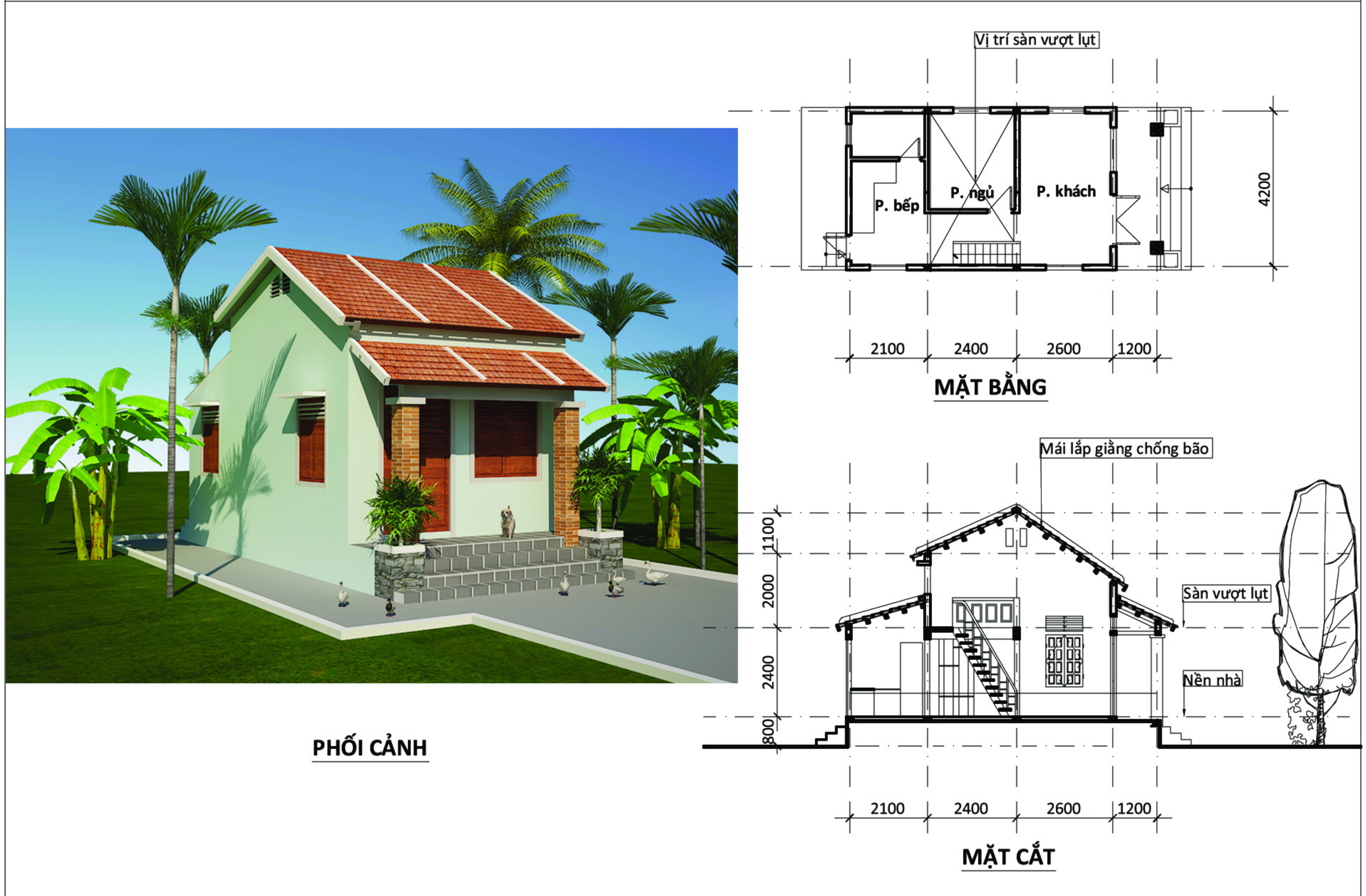
MẪU 4: Xây mới hoàn toàn hoặc cải tạo một gian trong nhà cũ làm sàn vượt lụt
